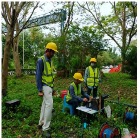
การสำรวจธรณีฟิสิกส์ด้วยวิธีวัดค่าความต้านทานไฟฟ้าในแนวตั้ง บริเวณบ่อบำบัด
