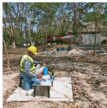
สูบทดสอบบ่อ BH-04 และวัดระดับน้ำบ่อสังเกตการณ์ BH-03 ครั้งที่ 2 วันที่ 27 กุมภาพันธ์ 2566
