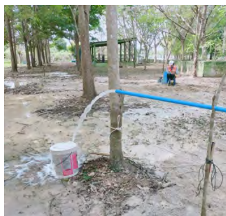
สูบทดสอบบ่อ BH-04 และวัดระดับน้ำบ่อสังเกตการณ์ BH-03 ครั้งที่ 1 วันที่ 8 มกราคม 2566
