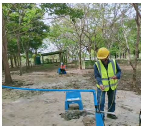
สูบทดสอบบ่อ BH-04 และวัดระดับน้ำบ่อสังเกตการณ์ BH-03 ครั้งที่ 1 วันที่ 8 มกราคม 2566
