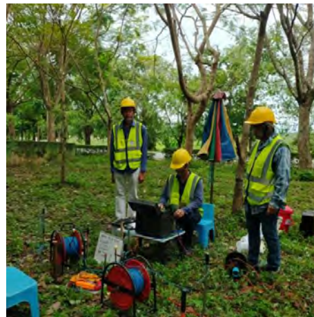
การสำรวจธรณีฟิสิกส์ด้วยวิธีวัดค่าความต้านทานไฟฟ้าในแนวตั้ง บริเวณบ่อบำบัด
