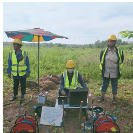
การสำรวจธรณีฟิสิกส์บนผิวดินแบบภาคตัดขวางแบบ 2 มิติ บริเวณด้านตาช้าง
